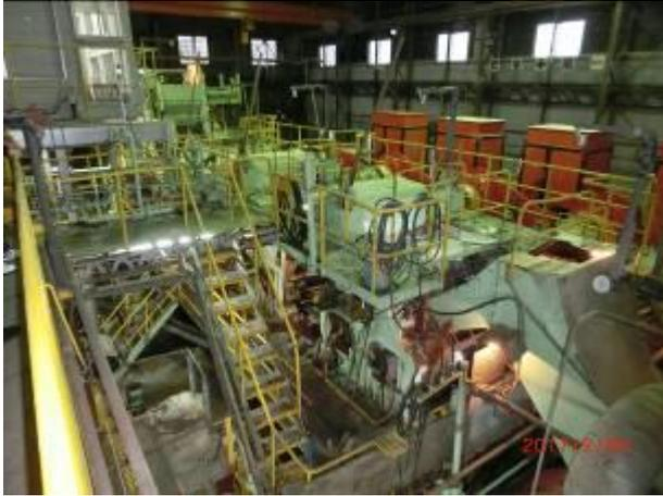
次にうかがった「南栄製糖株式会社」の関口工場長から、さとうきびから砂糖ができるまでを詳しくお聞きし、4階建ての工場見学をしました。さとうきびは生育時期には地球温暖化を防止し、圧縮する工程で出るバガス（搾りかす）は燃料（製糖設備へバイマオス発電）となり、電力を使っていない、さらに残りは肥料になるなど、全く無駄がない素晴らしい島の宝物、いずれ
